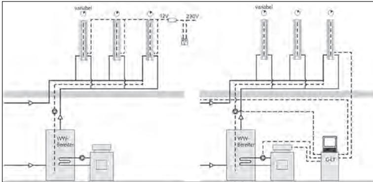
DE Elektronikanschluss thermische Desinfektion, 00 845 28 99
