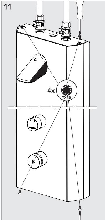
DE 6 Schraube einschrauben und Paneel einhängen
