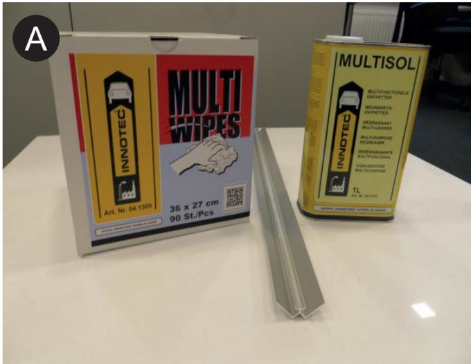
Eckprofil auf das richtige Maß schneiden, mit MULTISOL und MULTI WIPES reinigen/entfetten und ca. 5 Minuten ablüften lassen. ACHTUNG: Multisol immer direkt auf das Multi Wipes Tuch auftragen!
