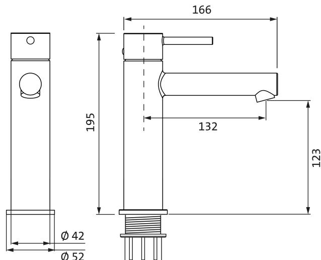
Lochbohrung Ø 35 mm
