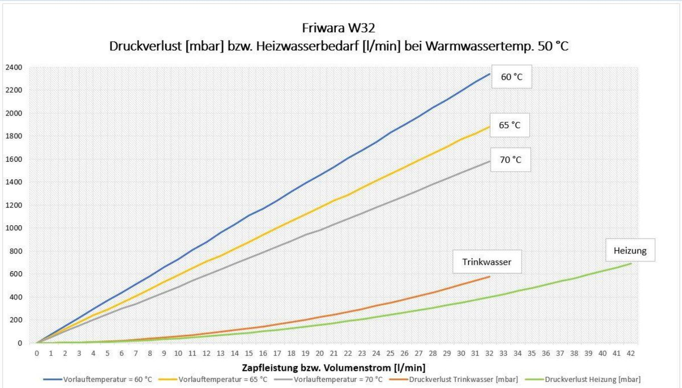
Der Druckverlust auf der Heizungsseite wird durch die integrierte pulsweitenmodulierende Pumpe der Frischwasserstation überwunden. Es sollte auf der Heizungsseite ein Differenzdruck von max. 200 mbar eingehalten werden.
