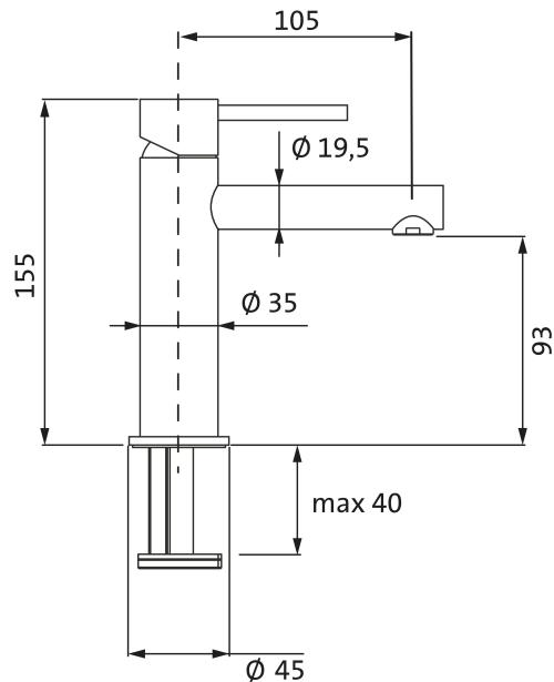
Lochbohrung  $\varnothing$  35 mm
