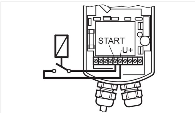
Abb. 3 Differenzdruckschalter
