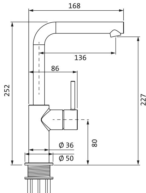
Lochbohrung Ø 35 mm
