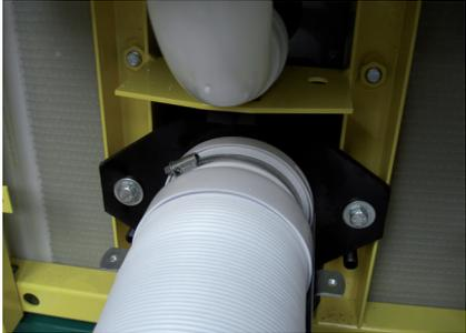
Flexschlauch mit vormontiertem Flansch und beiliegenden Schrauben am beweglichen Teil des Hauptrahmens befestigen
