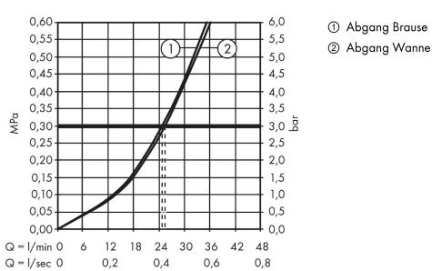
**Metropol****Einhebel-Wannenmischer Unterputz mit Bügelgriff und integrierter Sicherungskombination**
