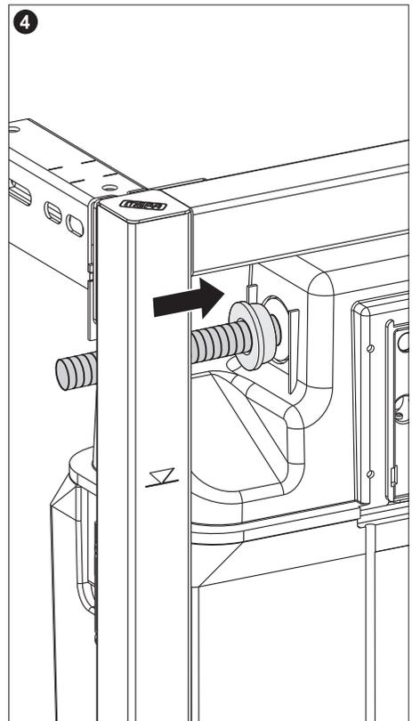
Den Rohrführungsstopfen mit dem Leerrohr in das freie Anschlussloch im UP-Spülkasten einstecken.
