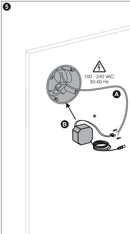
(A) Das UP-Netzgerät an die Netzzuleitung anschließen (100 - 240 VAC, 50 - 60 Hz).
