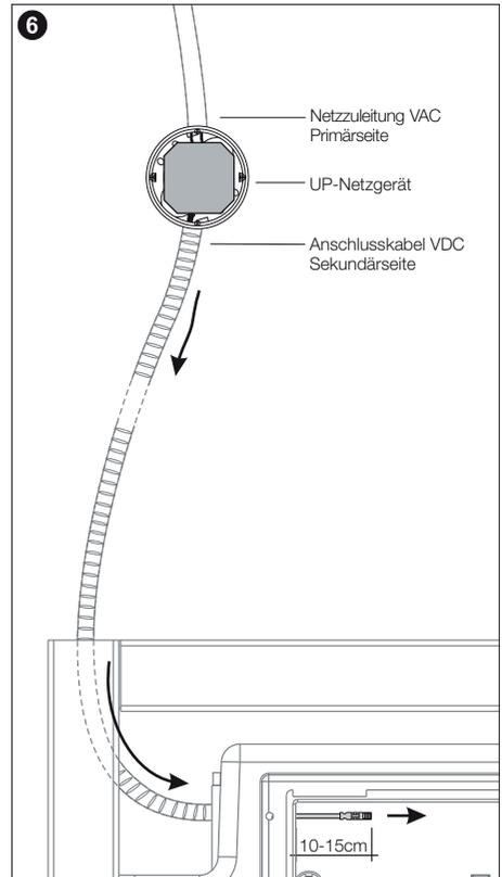
Das Anschlusskabel des UP-Netzgerätes zum Anschluss der WC-Elektronik (Sekundärleitung, 2,00 m Länge) durch das Leerrohr, das in den UP-Spülkasten führt, schieben.
