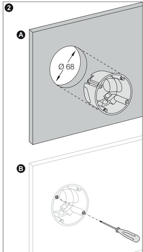
(A) Ausschnitt für die UP-Hohlwanddose in die Trockenbaubelplankung einbringen.
