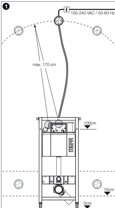
Die UP-Hohlwanddose zur Aufnahme des UP-Netzgerätes kann in einem maximalen Abstand von 170 cm (**Länge des mitgelieferten Leerrohres DN 20 beachten!**), gemessen vom Anschluss am UP-Spülkasten aus, installiert werden.
