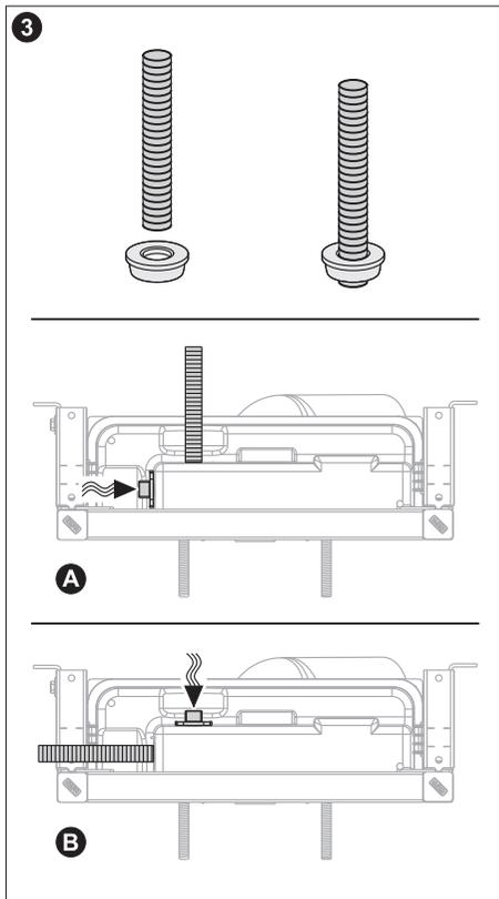
Das Leerrohr DN 20 in den Rohrführungsstopfen einstecken.
