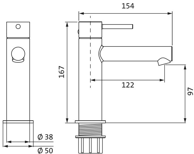
Lochbohrung Ø 35 mm
