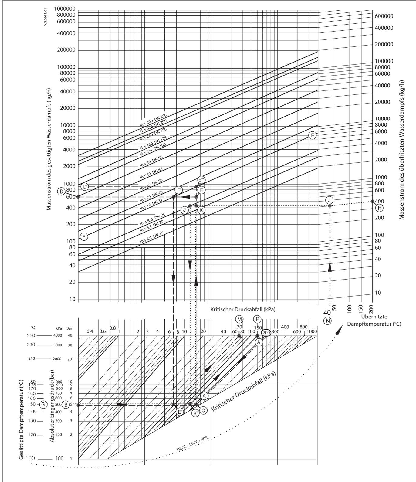
Die Größenbestimmung des Dampfventils basiert auf 40 % des absoluten Dampfdrucks (unmittelbar vor dem Ventil), der bei voller Öffnung über das Ventil abgelassen wird. In diesem Zustand bewegt sich der Dampf mit oder nahe seiner kritischen Geschwindigkeit
