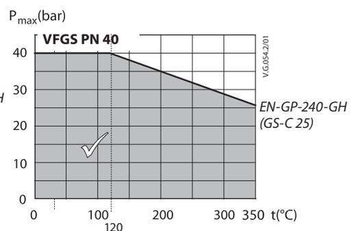
Maximal zulässiger Betriebsdruck als Funktion der Fördermediumentemperatur (gemäß EN 1092-1)
