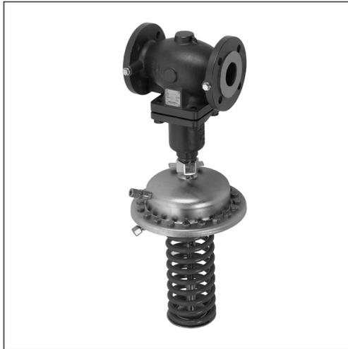
Der Regler ist ein selbsttätiger Druckminderungsregler, der in erster Linie für den Einsatz in Fernwärmesystemen vorgesehen ist. Der Regler ist drucklos geschlossen und öffnet sich bei steigendem Druck. Der Regler verfügt über ein Regelventil, einen Stellantrieb mit einer Stellmembran und einer Feder zur Druckeinstellung.
