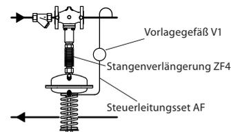
**VFG 21-Ventile (weich dichtender Kegel) – für Wasser**
