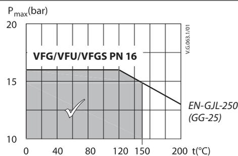
Maximal zulässiger Betriebsdruck als Funktion der Fördermediumentemperatur (gemäß EN 1092-2)
