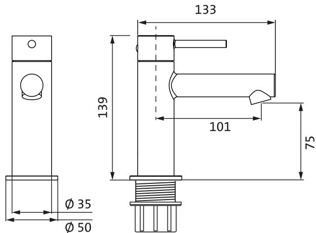
Lochbohrung Ø 35 mm
