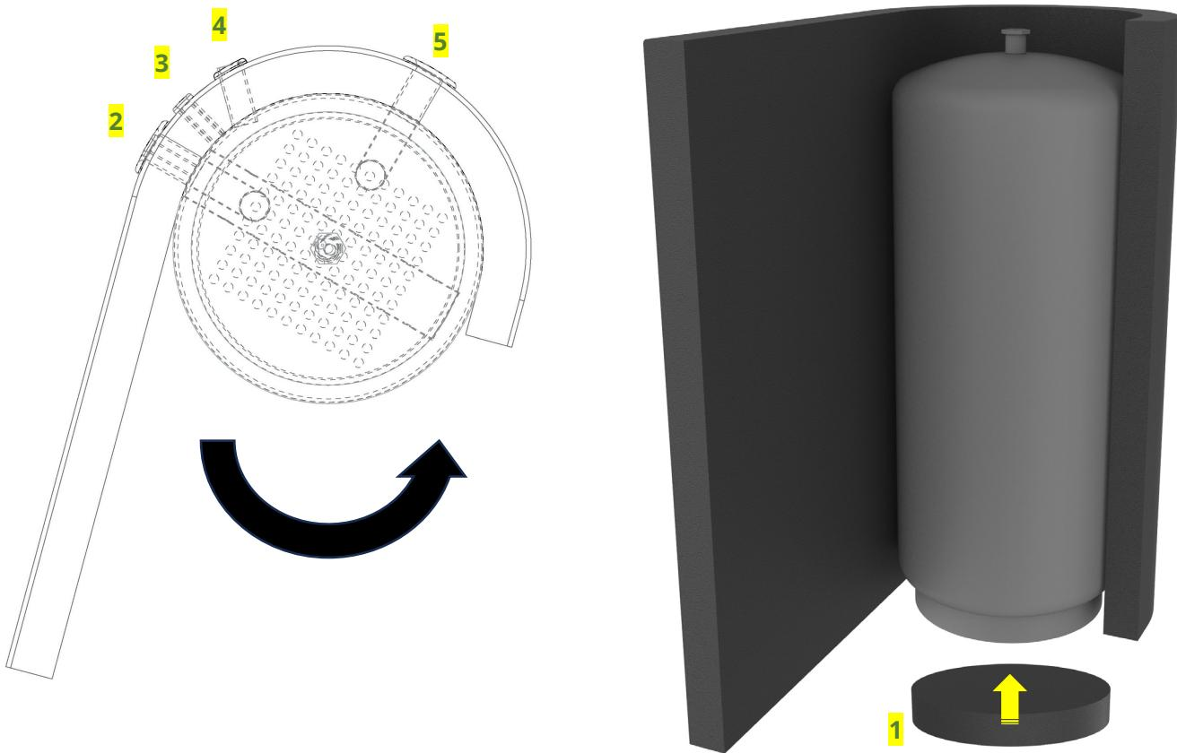
Die untere Dämmung am Boden des Energiespeichers ES anbringen (1). Die Dämmung bei den Muffen (2-5) einhängen, festhalten und kräftig an den Energiespeicher ES andrücken. Anschließend die Dämmung, wie auf der Zeichnung dargestellt, spannen und straff um den Energiespeicher ES legen. Unbedingt darauf achten, dass zwischen Dämmung und Energiespeicher ES kein Zwischenraum ist. Falls nötig, die Dämmung durch Drücken und Klopfen mit der flachen Hand straffen.
