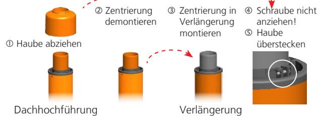
Abb. 4 Umbau der Dachhochführung und der Verlängerung
