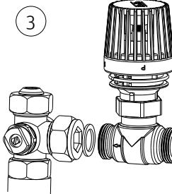
Montage der Warmwasservorrangschaltung
