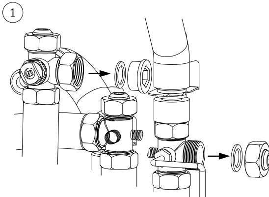
Demontage der Verschlussverschraubungen und der vormontierten Dichtungen.
