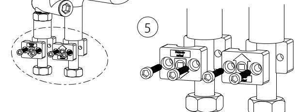
Anbringen und Verschrauben der vorderen Halbschalen der Rohrhalter
