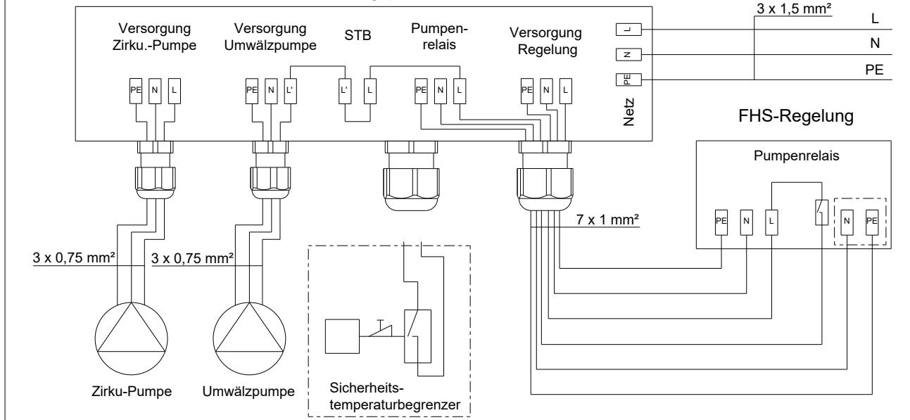
Elektro-Anschlussbox mit Verdrahtungsplatine BM FH C
