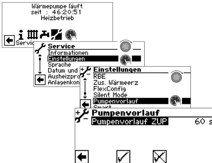
**Pumpenvorlauf VBO** Pumpenvorlauf Soleumwälzpumpe
