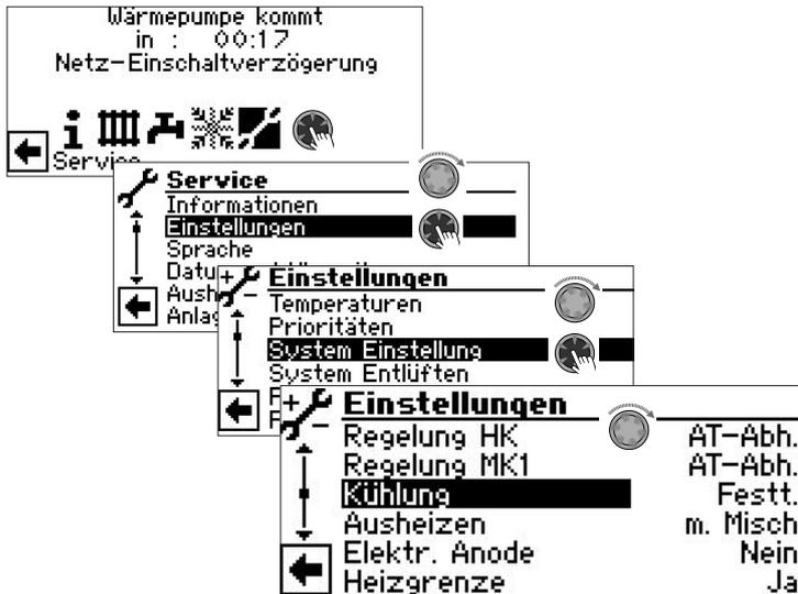
Bei Einstellung „Festt.“ entspricht die Vorlauftemperatur der Kühlung der eingestellten Solltemperatur des Mischkreises 1 (MK 1):
