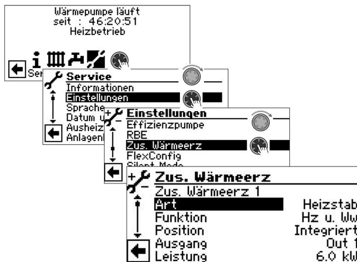
Hier können Sie angeschlossene zusätzliche Wärmeerzeuger aktivieren und deren Parameter einstellen oder angeschlossene zusätzliche Wärmeerzeuger deaktivieren
