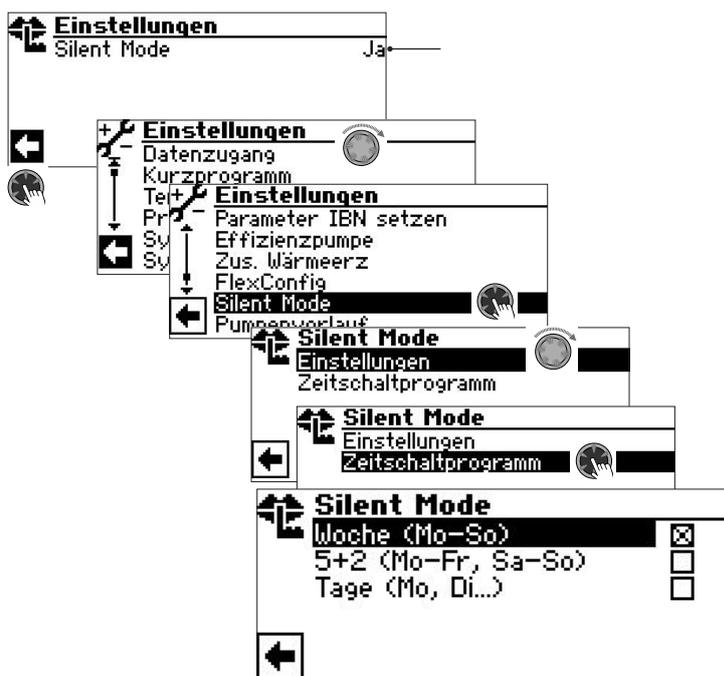
Die Programmierung der Laufzeiten des Silent Mode erfolgt wie im Abschnitt „Einstellen der Schaltzeiten des Heizkreises“ beschrieben.
