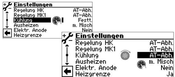
Bei Einstellung „AT-Abh.“ bleiben eingestellte Solltemperaturen unberücksichtigt. Stattdessen werden Solltemperaturen in Abhängigkeit von der Außentemperatur automatisch errechnet.
