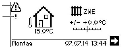
Während des Notfallmodus ist die Verdichteranforderung gesperrt. Um den Heizbetrieb und die Trinkwarmwasserbereitung zu gewährleisten, als Betriebsart „Heizung“ und Betriebsart „Trinkwarmwasserbereitung“ die Option „Zus. Wärmeerz.“ einstellen.
