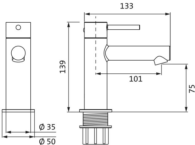
Lochbohrung Ø 35 mm
