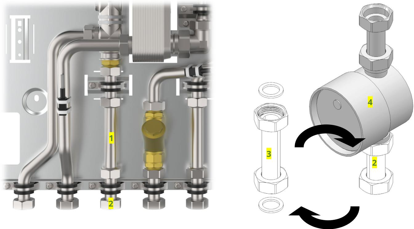
Zur Installation eines 80 mm-Wasserzählers im PWC-Strang ist das untere Rohrstück (2) durch das Friwara WM-Rohrstück 80 mm (3) zu ersetzen. Hierzu die vorhandene Rohrschelle lösen, das vorhandene Rohrstück entnehmen und durch das neue Rohrstück ersetzen.
