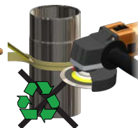
Abb. 5: Außenrohr kürzen und entgraten
