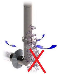
Abb. 11: Verbrennungsluft-Ansaugung frei halten
