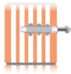
Abb. 8: Beispiel, Injektionsankerbefestigung bei Mauerwerk
