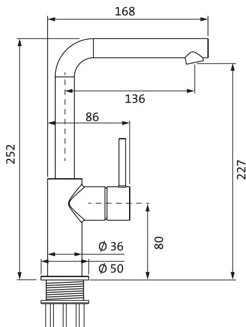
Lochbohrung Ø 35 mm
