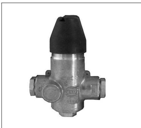
Die Funktion des Drosselventils besteht darin, die Durchflussgeschwindigkeit durch die Steuerleitung zu regeln und somit die Reaktionszeit des PCV zu beeinflussen. Der Einfluss auf die Reaktionszeit ist nicht fest definiert und hängt in starkem Maße von den Applikationsbedingungen ab. Demzufolge kann der Einfluss von Applikation zu Applikation beträchtlich variieren.
