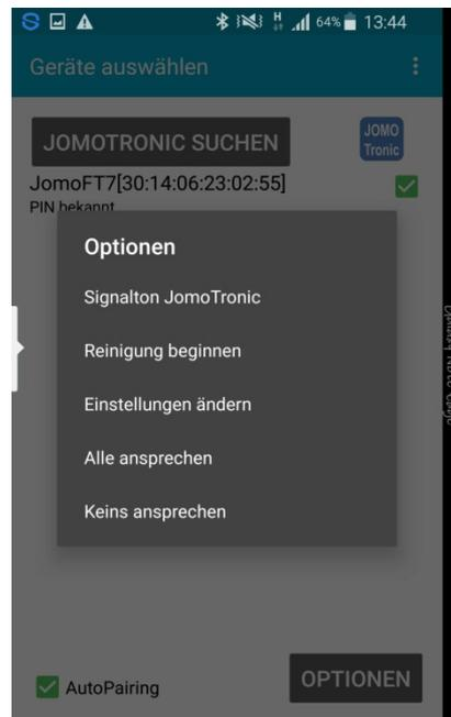
Nach dem Aktivieren des Buttons „Reinigung beginnen“ können Sie in Ruhe die Keramik reinigen, ohne dass die JOMOTronic spült. Unter „Einstellungen ändern“ können Sie die Spülzeiten etc. verändern.
