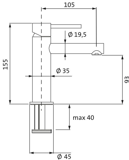
Lochbohrung  $\varnothing$  35 mm
