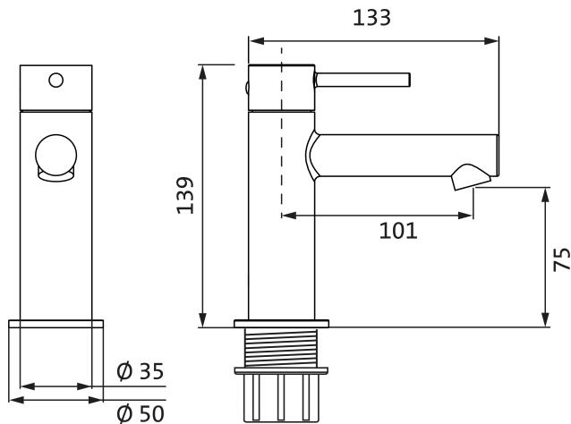
Lochbohrung Ø 35 mm
