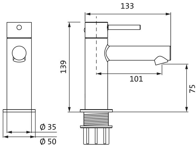
Lochbohrung Ø 35 mm
