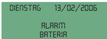
Anzeige Batterie defekt
