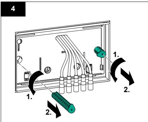
> Lösen Sie die Distanzbolzen und legen Sie sie zur Seite.
