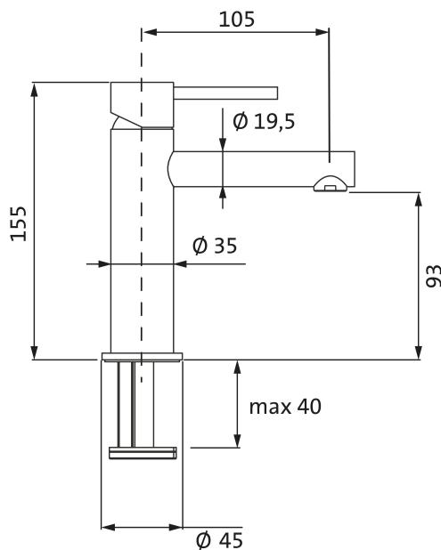
Lochbohrung  $\varnothing$  35 mm
