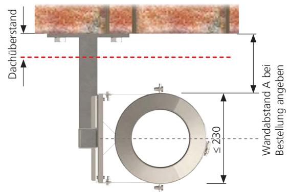
Die Lasteinleitung und Auswahl der Schwerlastanker ist bauseits durch einen Statiker festzulegen.
