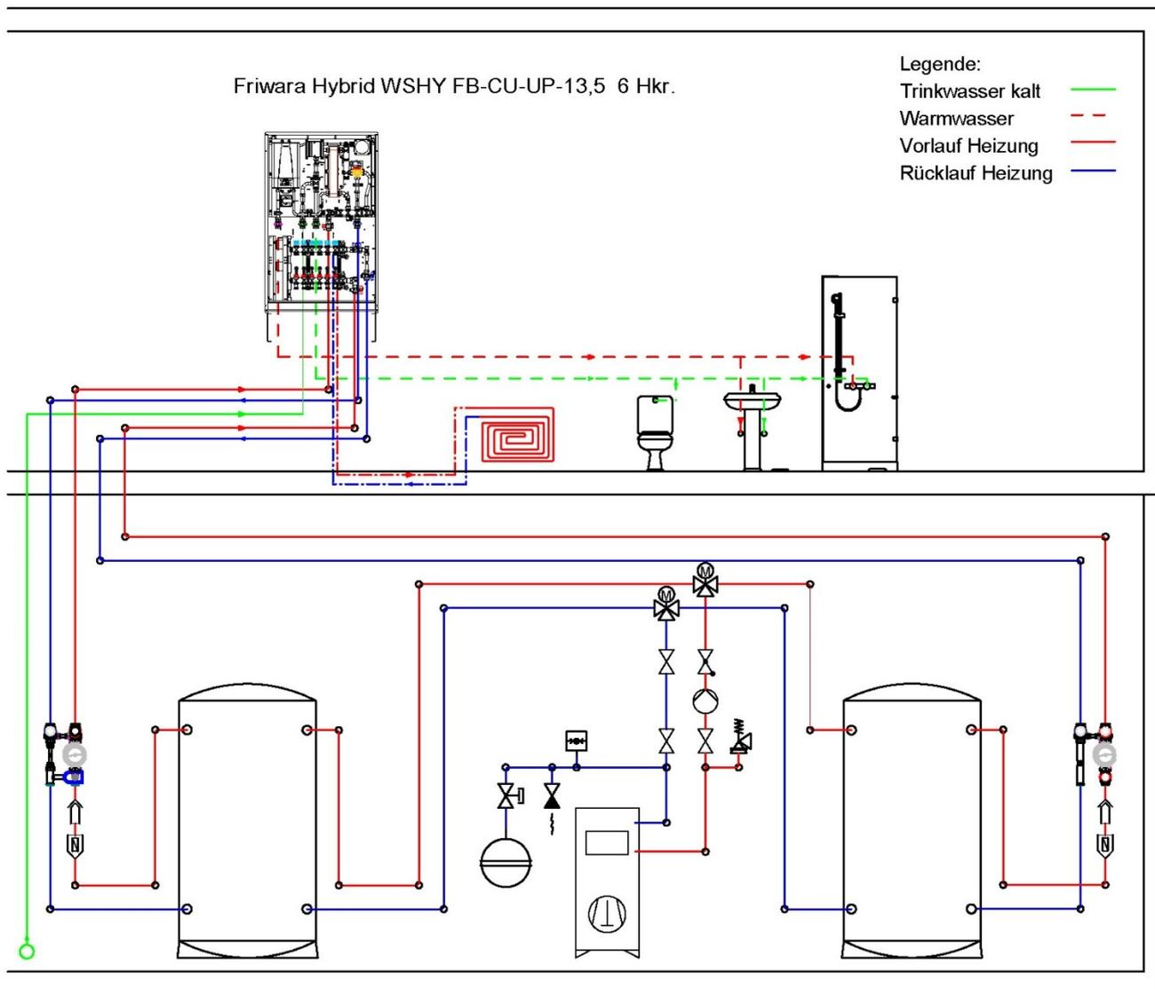
Der linke Pufferspeicher dient der Warmwasserbereitung.
