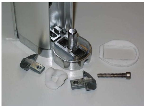
2) Teile des „alten“ Hubmechanismus demontieren
