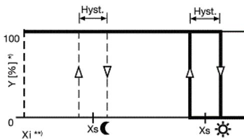
Verlauf der Einschaltzeit (Tastverhältnis) in Abhängigkeit von der Temperatur.
