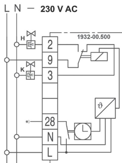
\*) Hinweis: An Klemme 28 (abgehende Betriebsspannungs-Phase bewirkt Betriebsart Absenken) können weitere Raumthermostate mit Temperaturabsenkfunktion angeschlossen werden.
