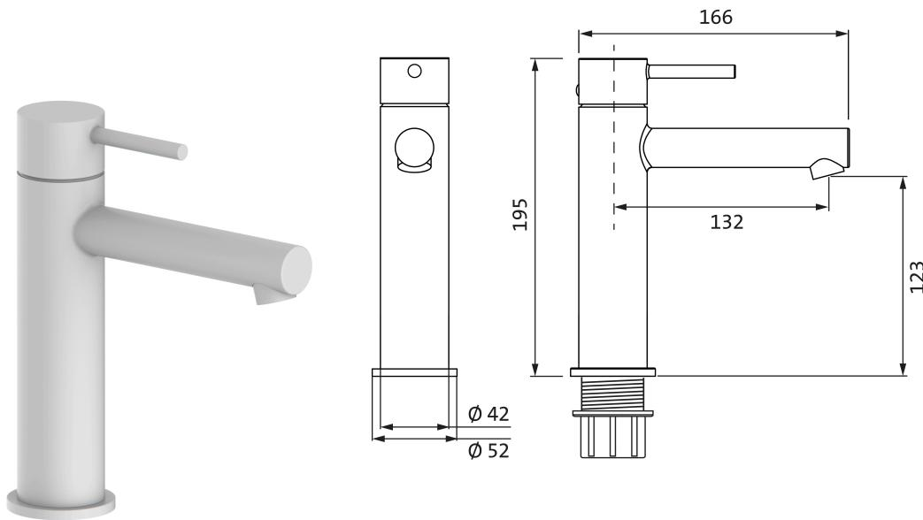
Lochbohrung Ø 35 mm
