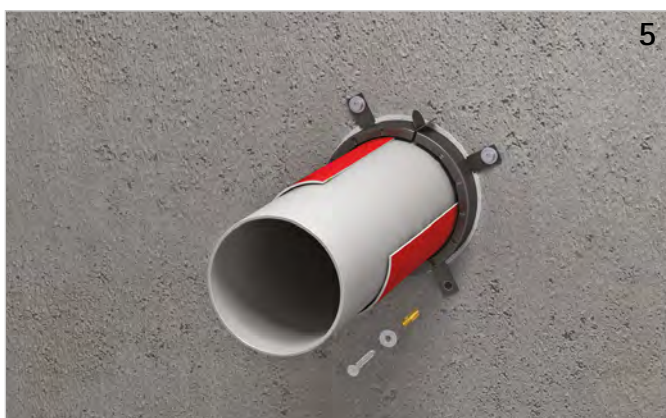
Andübeln der Haltelasche mit dem mitgelieferten Befestigungsset.
