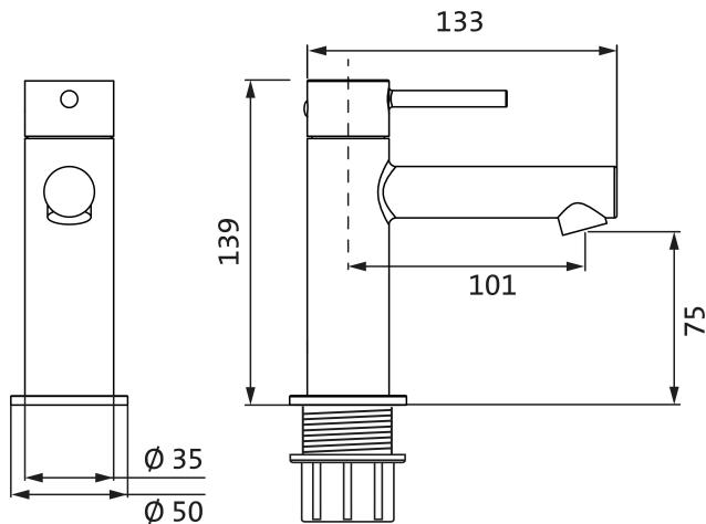
Lochbohrung Ø 35 mm
