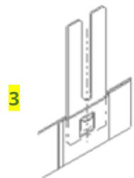
Der Frontrahmen kann nun an der Einbauzarge mit Hilfe der Flügelmuttern (4) befestigt werden.
