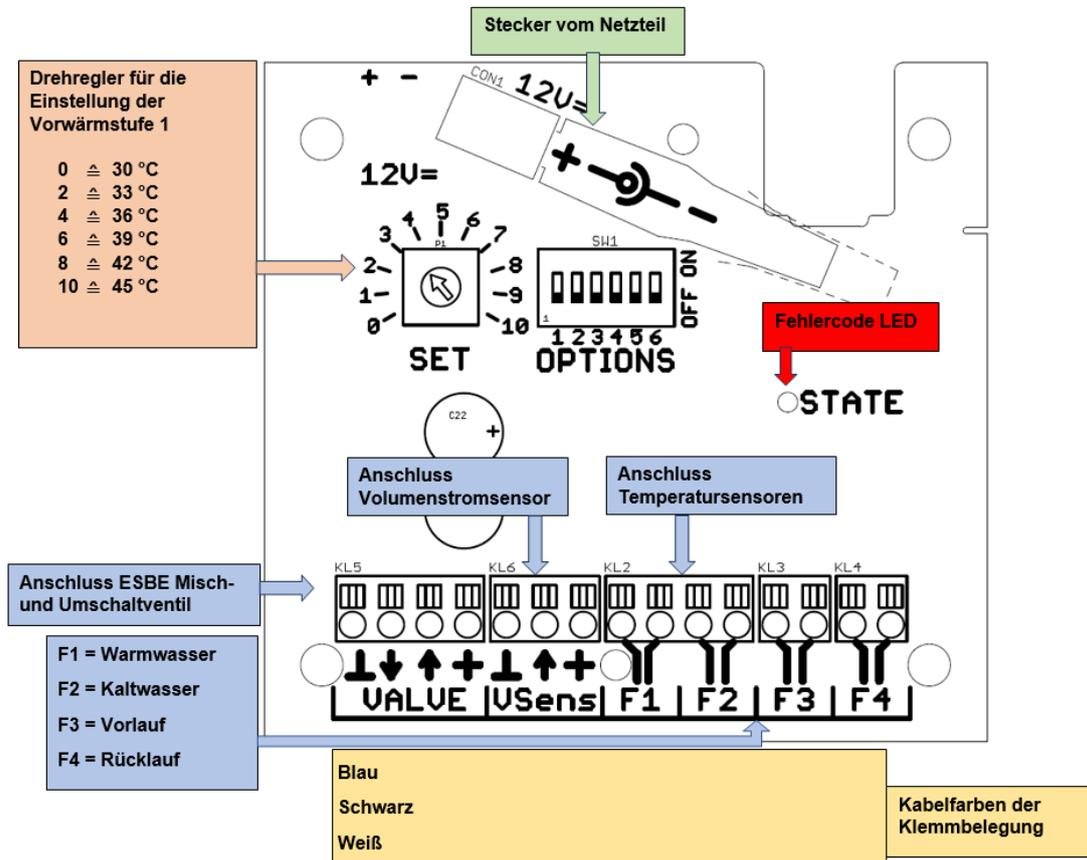
Der Regler ist im Auslieferungszustand mittels dem Dipschalter auf Version 9 und die Vorwärmstufe 1 ist auf ca. 35°C mit der Stellung 3 programmiert.
