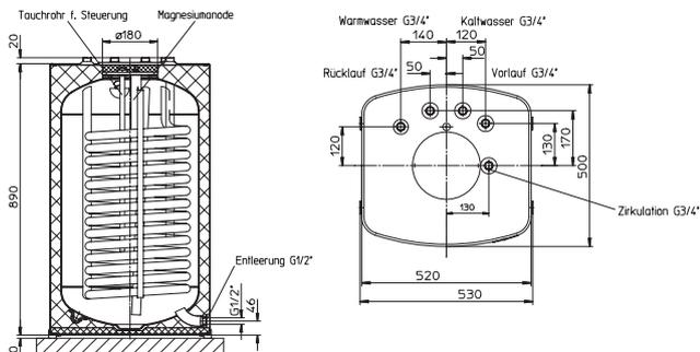
Anschlussituation bei hängender Montage
