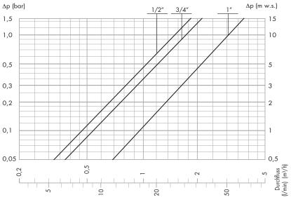
Empfohlene Durchflussmengen für einen stabilen Betrieb und eine Präzision von ±2°C
