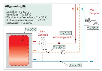
Daher muss in die Ausgangsleitung von dem Warmwasserspeicher an der Eintrittsstelle in das Verteilungsnetz ein Thermostatmischer installiert werden, der Folgendes garantiert:
