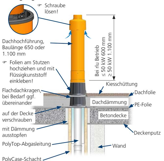
Abb. 43: Dachdurchführung DN 60/100 - 110/160
