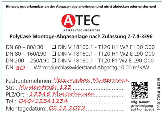
Abb. 48: Beispiel ausgefüllter Zulassungsaufkleber
