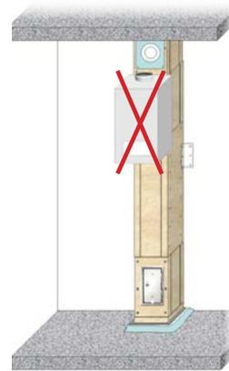
Abb. 46: Heizgeräte nicht direkt an den Schacht anbauen
