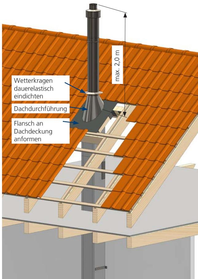
Abb. 41: fertige Mündungsausführung für PolyCase DN 100 bis 250
