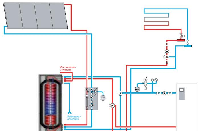
Wärmeerzeuger mit Thermotank Quadroline Kombispeicher, solare Erwärmung des Trinkwassers und solare Heizungsunterstützung, Fußbodenheizung
