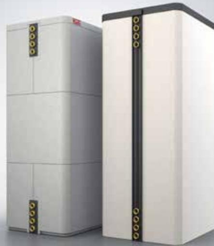
■ Die korrosionsfreien Roth Thermotanks Quadroline bestehen aus einzigartigem Kunststoff-Composite-Material mit Alu-Diffusionsschutz und äußerer EPS-Hochleistungsdämmung. Ihre Druckbeständigkeit beträgt 3 Bar und die maximale Betriebstemperatur 90 °C.
