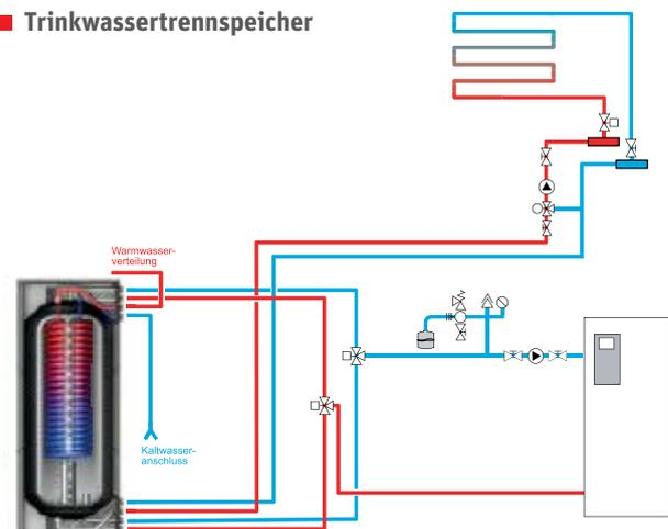
Wärmeerzeuger mit Thermotank Quadroline Trinkwassertrennspeicher, Trinkwasserzone und Pufferzone, Fußbodenheizung
