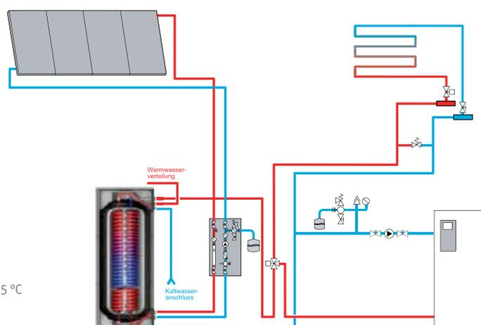
Wärmerezeuger mit ThermoTank Quadroline Trinkwassererwärmer mit Solar, solare Erwärmung des Trinkwassers, Fußbodenheizung
