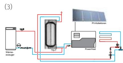
Einfache direkte Montage an einen Pufferspeicher
