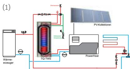
Einfache Montage an einen Trinkwasserspeicher mit integriertem Solarwärmetauscher
