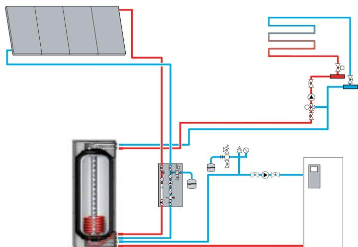
Wärmeerzeuger mit Thermostank Quadroline Solarspeicher, keine Trinkwassererwärmung, solare Heizungsunterstützung, Fußbodenheizung über Trennspeicher (hydraulische Weiche)
