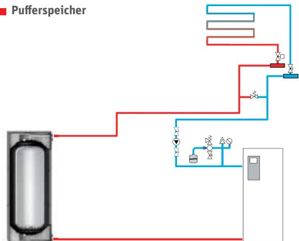
Wärmeerzeuger mit ThermoTank Quadroline Pufferspeicher, keine Trinkwassererwärmung, Fußbodenheizung mit Pufferspeicher zur Volumenvergrößerung
