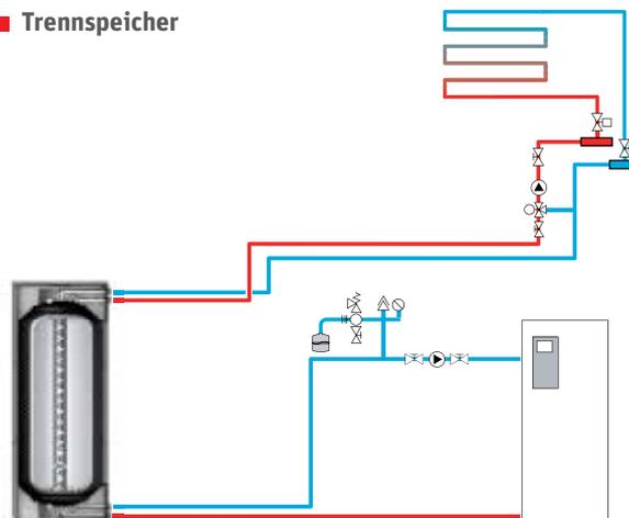
Wärmeerzeuger mit Thermostank Quadroline Trennspeicher, keine Trinkwassererwärmung, Fußbodenheizung über Trennspeicher (hydraulische Weiche)
