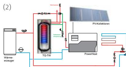
Einfache direkte Montage an einen Trinkwasserspeicher
