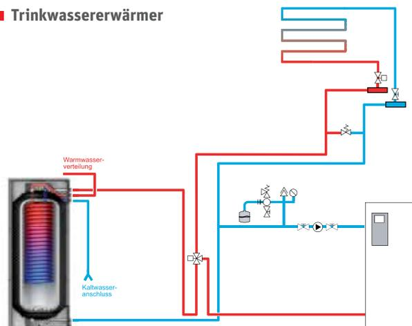
Wärmerezeuger mit Thermotank Quadroline Trinkwassererwärmer, Fußbodenheizung
