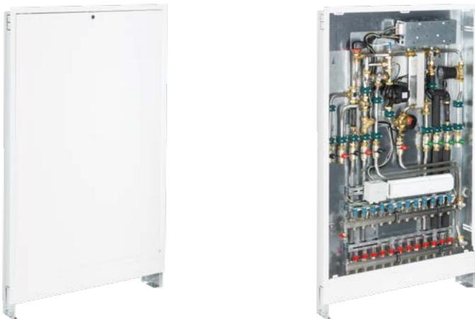
Vorkonfektionierte Wohnungsübergabestation mit geringer Bautiefe, elektronisch geregelter Trinkwassererwärmung und integrierter Heizwärmeverteilung.
