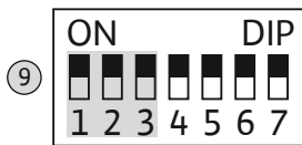
Fig. 19: DIP-Schalter 2: Überwachen der Betriebsparameter
