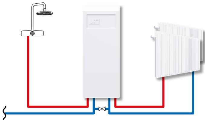
Befestigt zwischen der Hauptwasserversorgung und dem Heizungssystem. Ventil öffnen, um Wasserverluste des Heizungssystems zu ersetzen.
