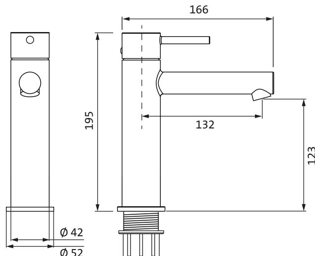
Lochbohrung Ø 35 mm
