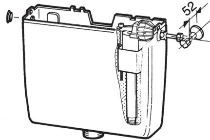
Sie können das Eckventil wahlweise rechts (werkseitig vormontiert), links oder hinten mittig anschließen. Das Eckventil ist mit einem Abstand von 52 mm von Fertigwand bis Mitte Anschluß zu montieren. Das verchr. Anschlußrohr ist entsprechend abzulängen.
