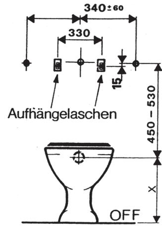
Kennzeichnen Sie, mit Hilfe beiliegender Schablone, die Position der Bohrungen für die Aufhängelaschen. Befestigen Sie die Aufhängelaschen mit beiliegenden Dübeln  $\varnothing$  8 mm und Holzschrauben 4,5 x 40 mm.
