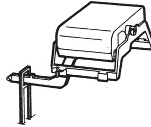
Beachten Sie bitte, daß bei der Montage des Lagerbocks mit Drückertaste der Betätigungshebel in die Zugklammer des Ablaufventils eingreift (siehe Zeichnung).
