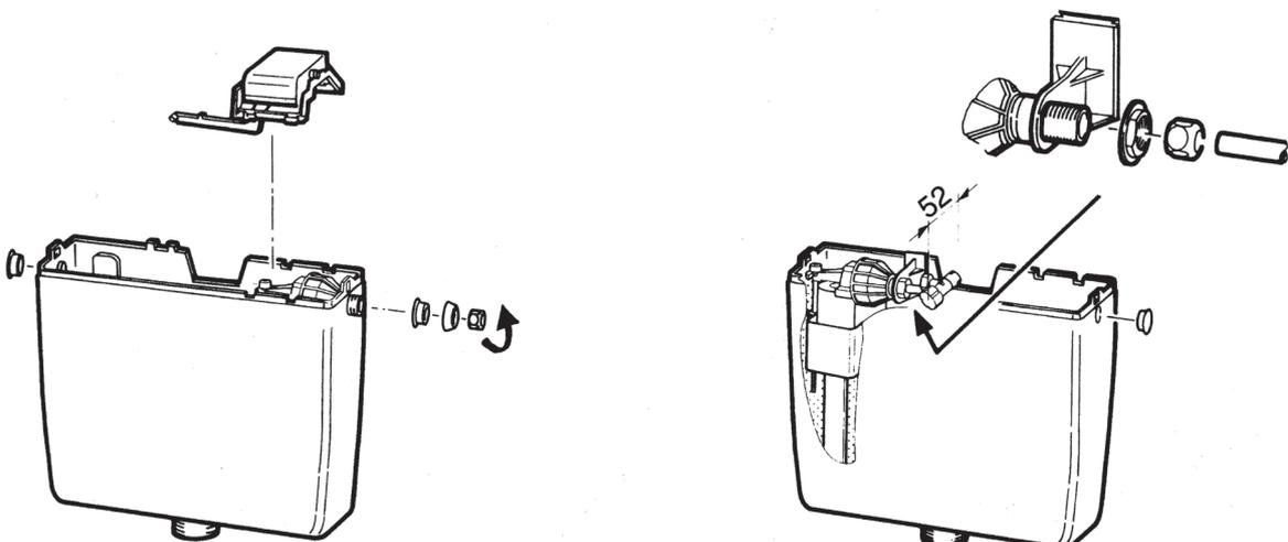
Bei rückseitigem Wasseranschluß wird zuerst das verchr. Kupferrohr auf 60 mm gekürzt, in das Eckventil eingesteckt und verschraubt. Danach wird das Füllventil in die Kunststoffhalterung gesteckt, mittels Kunststoffmutter arretiert und mit dem anderen Ende des Kupferrohres verschraubt. Anschließend werden die Verschraubungen fest angezogen.
