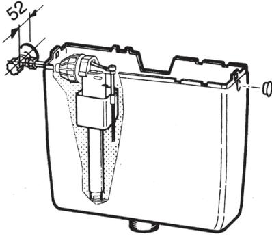
Für seitlichen Anschluß links, ist das Füllventil, wie in der Zeichnung dargestellt, umzumontieren.
