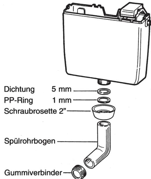
Der Spülrohrbogen wird mittels Schraubrossette, PP-Ring und Dichttring mit dem Spülkasten verbunden. Der Spülrohrbogen mit Gummi-Euroverbinder wird in den Toilettenkörper eingesteckt.
