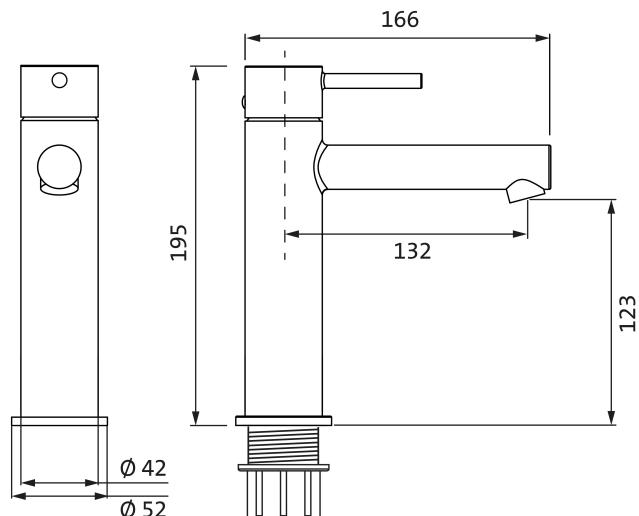
Lochbohrung Ø 35 mm
