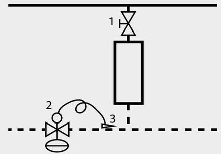
1. Heizkörperventil (ohne Fühler) (RV)
