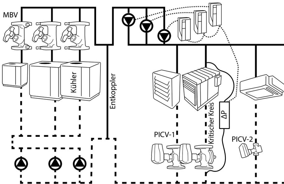
Dieses System ist eine Variation eines konstanten Primärsystems (konstanter Durchfluss\*). Frequenzumrichter werden zur Regelung der Pumpen auf der Sekundärseite eingesetzt. Durch Entkoppeln des Primär- und des Sekundärkreislaufs können die Kühler entsprechend der Lastschwankung abgestuft werden, während an den Kühlern ein konstanter Durchfluss\* aufrechterhalten wird. (Sekundärseite Beschreibung siehe Anwendungen: 1.1.1.1-1.1.1.3)
