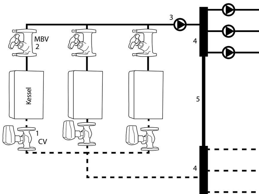
Dies ist die üblichste Anordnung von Kesselanlagen mit konstantem Primärdurchfluss (Kaskade). Primär- und Sekundärsystem sind voneinander hydraulisch unabhängig. Die Verteiler sind mit einem Bypass verbunden, der eine Wasserzirkulation zwischen ihnen ermöglicht.
