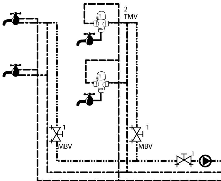
In dieser Anwendung stellen wir einen konstanten Durchfluss\* in der Warmwasser-Zirkulationsleitung unabhängig von temporärer Warmwassernutzung und Bedarf sicher. TMV (optional) sorgt für eine maximal begrenzte Zapftemperatur und verhindert Verbrühungen.
