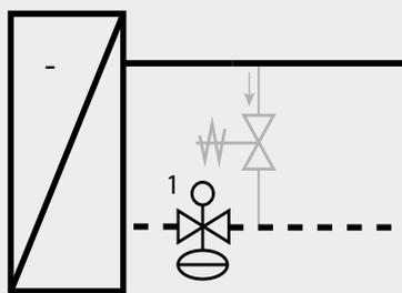
1. Druckunabhängiges Regelventil (PICV)
