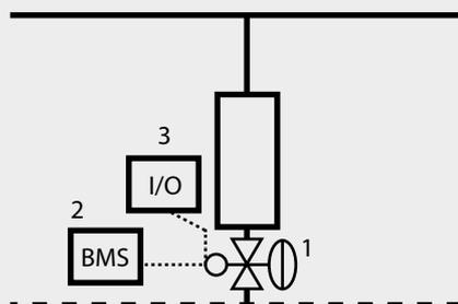
1. Druckunabhängiges Regelventil (PICV)
