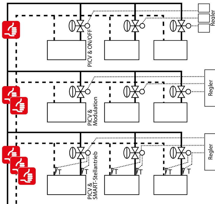
Die PICV-Technologie ermöglicht den Einsatz der proportionalen oder Schlechtpunkt-Pumpenregelung (basierend auf dem  $\Delta p$ -Fühler)
