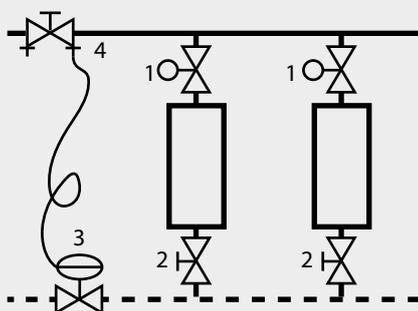
1. Thermostatisches Heizkörperventil (TRV)
