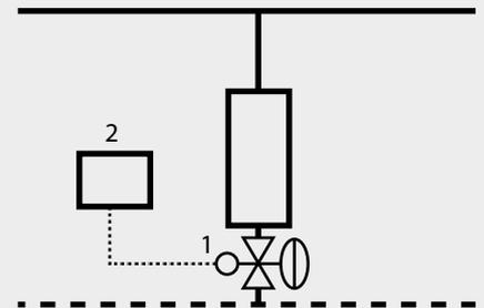
1. Druckunabhängiges Regelventil (PICV)
