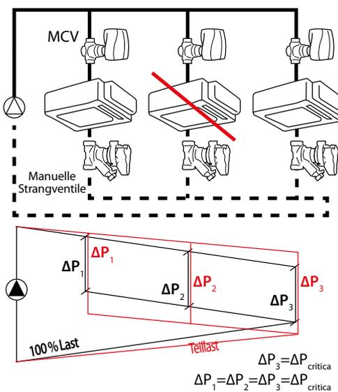
Abb. 11.2 Teillast – Umkehr-Rücklaufsystem
