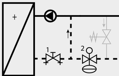
1. Druckunabhängiges Regelventil (PICV)
