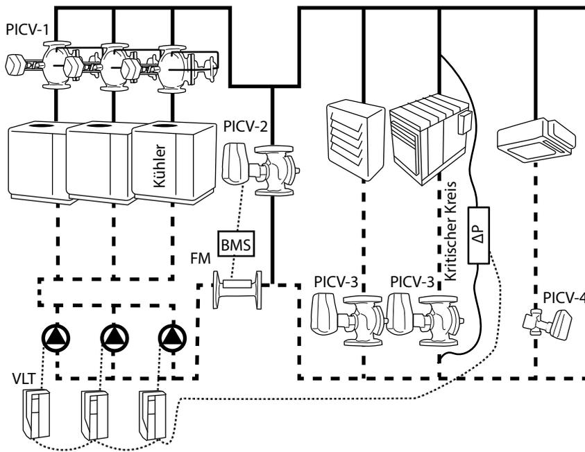
Für ein System mit variablem Durchfluss\* gilt dies als das effizienteste System für den thermischen Betrieb eines Gebäudes. Die Kühler können mehrere drehzahlgeregelte Verdichter haben. Dieses System verfügt über einen variablen Primär- (und Sekundär-) Kreislauf, in dem keine Sekundärpumpen vorhanden sind. Der Bypass dient zur Regelung des Mindestdurchflusses für die Kühler im Teillastbetrieb.
