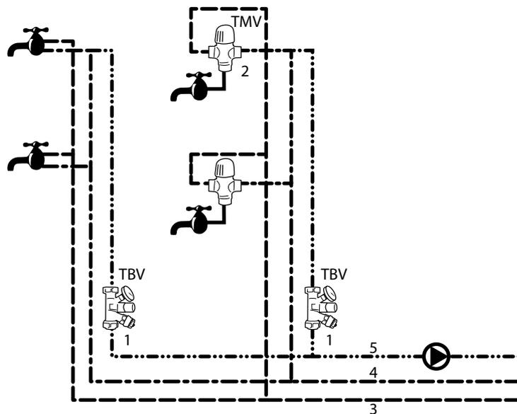
In dieser Anwendung stellen wir einen variablen Durchfluss\* im Warmwasserzirkulationsnetz\* und eine konstante Zapftemperatur\* an den Zapfstellen sicher, unabhängig von der Entfernung vom Speicher und temporärem Warmwasserbedarf. Damit reduzieren wir die Zirkulationswassermenge zu allen Zeiten. Eine thermische selbsttätige Desinfektion ist aufgrund eines speziellen Moduls in MTCV-Ventilen möglich. TMV (optional) sorgt für eine maximal begrenzte Zapftemperatur und verhindert Verbrühungen.
