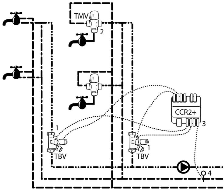
In dieser Anwendung stellen wir einen variablen Durchfluss\* im Warmwasserzirkulationsnetz\* und eine konstante Zapftemperatur\* an den Zapfstellen sicher, unabhängig von der Entfernung vom Speicher und temporärem Warmwasserbedarf. Damit reduzieren wir die Zirkulationswassermenge zu allen Zeiten. TMV-Ventile sorgen auch in Bezug auf die thermische Desinfektionszeit für eine konstante Zapftemperatur\*. Die thermische Desinfektion\* wird durch einen elektronischen Regler CCR2+ geregelt.
