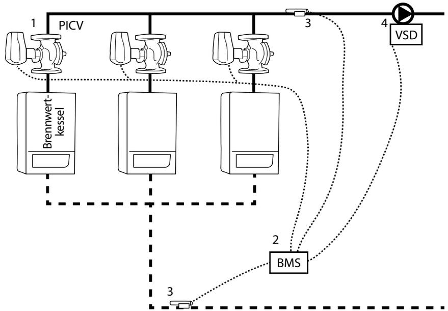
Bei dieser Anwendung wird eine unterschiedliche Anzahl von Brennwertkesseln eingesetzt. Alle Kesselkreise sind mit PICV-Ventilen ausgestattet, die an das BMS-System angeschlossen sind. Sie gewährleisten den ordnungsgemäßen Abgleich und stufenweise Regelung unter Voll- und Teillastbedingungen. Frequenzumrichter werden zur Minimierung der Pumpkosten\* eingesetzt. Eine PICV- oder  $\Delta p$ -Regelung auf der Sekundärseite wird ebenfalls dringend empfohlen, um den Energieverbrauch zu minimieren.
