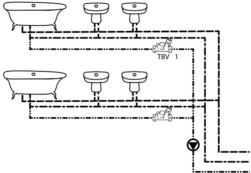
In dieser Anwendung stellen wir variablen\* Durchfluss im Warmwasserzirkulationsnetz\* und konstante Zapftemperatur an Zapfstellen sicher, unabhängig von der Entfernung vom Speicher und temporärem Warmwasserverbrauch. Damit reduzieren wir die Zirkulationswassermenge zu jeder Zeit. Thermische Desinfektion\* ist mit zusätzlichen Komponenten möglich
