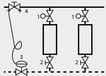
1. Thermostatisches Heizkörperventil (TRV)
