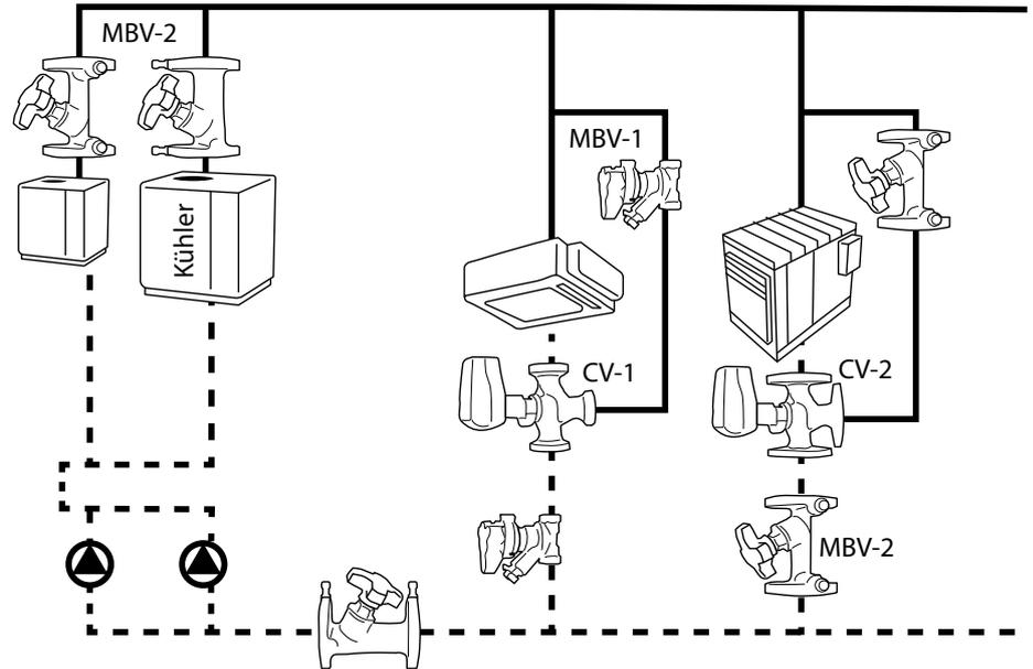
Dies ist eine der ältesten Kühleranwendungen ohne Frequenzumrichter für Pumpen und Kühler. Die Kühler können nur konstante Durchflussmengen verarbeiten. Daher befinden sich auf der Sekundärseite des Systems 3-Wege-Regelventile, um einen konstanten Durchfluss\* aufrechtzuerhalten. Diese regeln den Durchfluss durch die Endgeräte, um eine konstante Raumtemperatur aufrechtzuerhalten. (Sekundärseite Beschreibung siehe Anwendungen: 1.1.2.1, 2,2 und 3.2.1)
