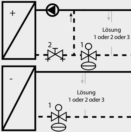
1. Druckunabhängiges Regelventil (PICV)
