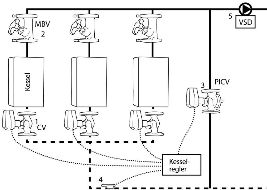
Diese Anwendung wird für herkömmliche (nicht kondensierende) Kessel verwendet. Um eine niedrige Einlasstemperatur in die Kessel zu vermeiden, ist ein geregelter Bypass (mit einem PICV) erforderlich. In dieser Anwendung verwenden wir nur eine Pumpen, um den Durchfluss sowohl durch das primäre als auch durch das sekundäre System zu zirkulieren
