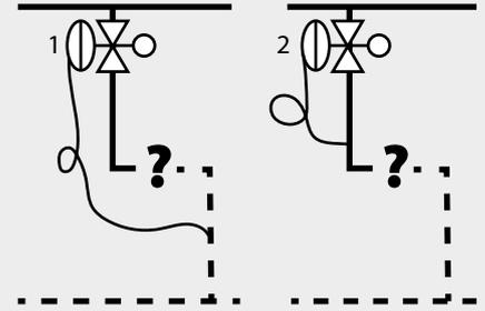
1. Kombiniertes automatisches Strangventil als  $\Delta p$ -Regler (PICV 1)
