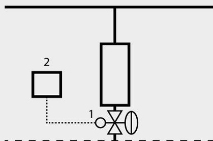
1. Druckunabhängiges Regelventil (PICV)
