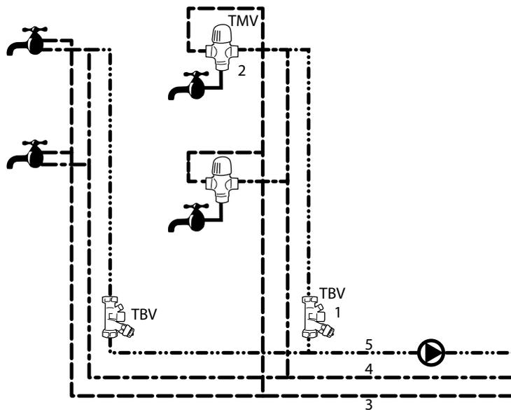
In dieser Anwendung stellen wir einen variablen Durchfluss\* im Warmwasserzirkulationsnetz\* und eine konstante Zapftemperatur\* an den Zapfstellen sicher, unabhängig von der Entfernung vom Speicher und temporärem Warmwasserbedarf. Damit reduzieren wir die Zirkulationswassermenge zu jeder Zeit. Thermische Desinfektion\* ist mit zusätzlichen Komponenten möglich. TMV (optional) sorgt für eine maximal begrenzte Zapftemperatur und verhindert Verbrühungen.
