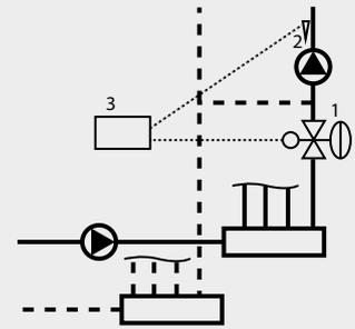
1. Druckunabhängiges Regelventil (PICV)
