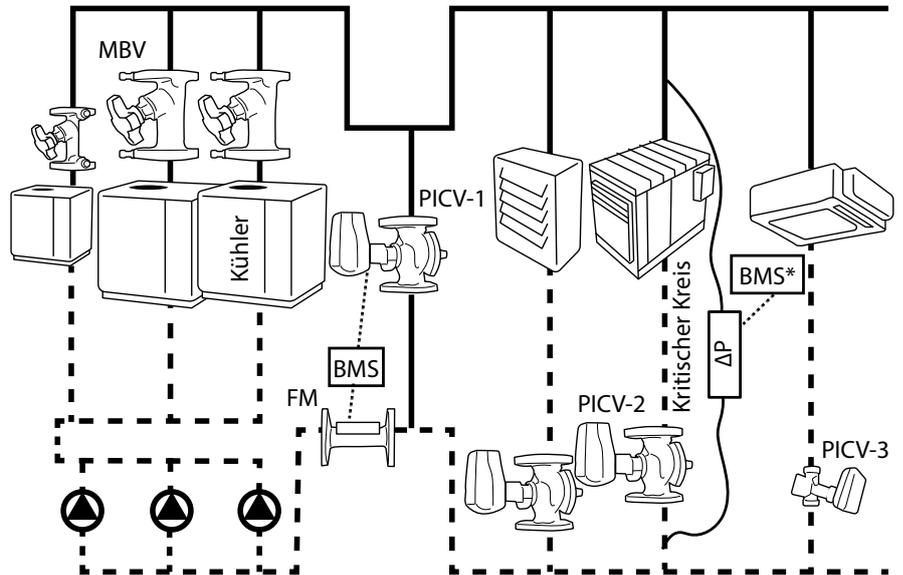
\*BMS – nur zur Überwachung, keine Pumpenregelung (optional)
