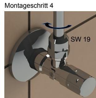
Kupferrohr / Flexschlauch bis zum Anschlag durch die Quetschverschraubung drücken und mit dem Gabelschlüssel festziehen.
